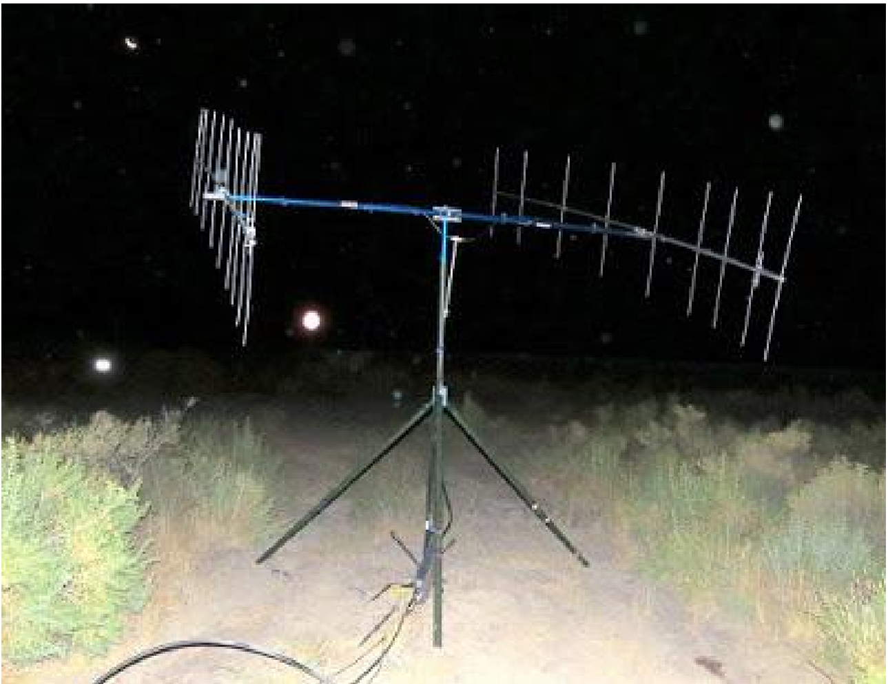
The 2 x 9 ele vpol yagis out in the dark
