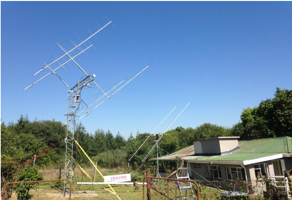
Left the 2 m array 4 x 9 ele horizontal and 4 x 6 ele vertikl, right 70 cm 2 x 9wl
